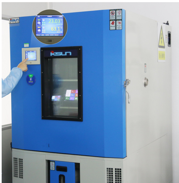
图 5-3 高低温老化测试图
